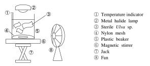
Fig. 2.2-1 Experimental apparatus
