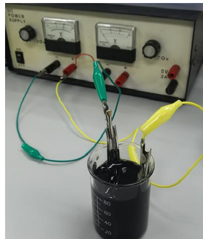
電気二重層コンデンサーの電極作成(コーティング)
