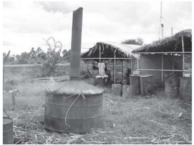
図9 キルンによるチャーの生産 (写真提供：ARTI)
