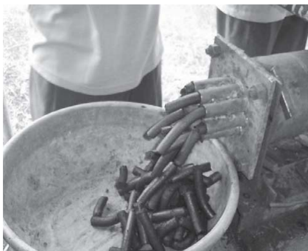
図10 押し出し成型機によるチャーのブリケット化 (写真提供：ARTI)
