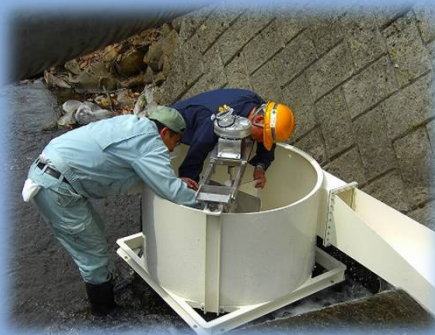
小水力発電機(川端鐵工) 「タライ水車」 低落差での発電や 流水に含まれるゴミに強い
