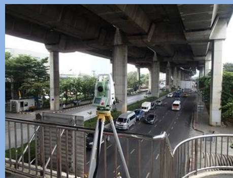
【高架橋でのデモンストレーション】 —100メートル離れた構造物のひび割れも計測可能
