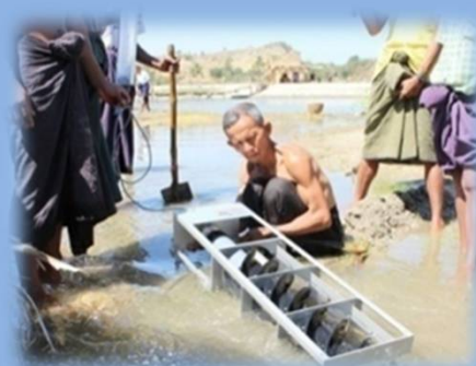
小水力発電機(角野製作所) 「ピコピカ水車」 微小発電ながら組立や 取り付が容易
