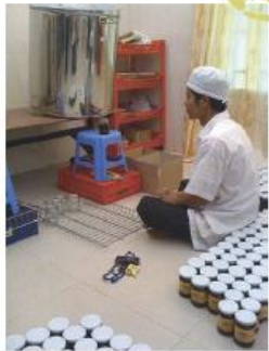
採取したハチミツをタンクからボトルに詰め、ラベルを貼って製品に。すべての製品の質が一定になるよう品質管理も支援
