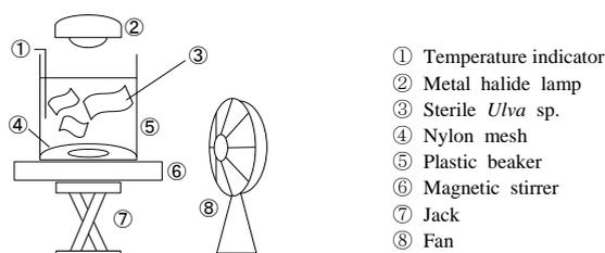
Fig. 2.2-1 Experimental apparatus
