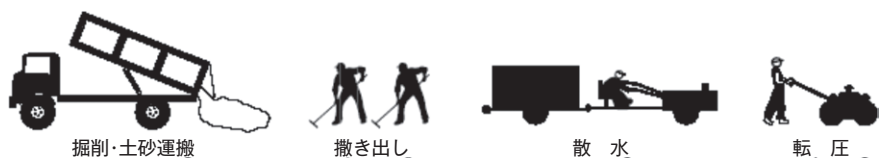
図3 LBTによる道路建設のフロー図
